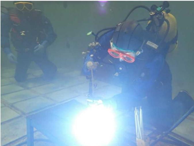
電気の火花により金属を溶かして、接合や切断をするアーク溶接やアーク溶断は、水中の鋼製構造物の修繕や沈船の引き上げなどでも用いられる。本校では水中溶接・溶断実習専用プールでどちらの技術も習得できる。
