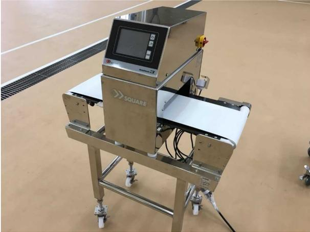
製品や仕掛品中の金属片を探知し、異物混入を防ぐための機器。
