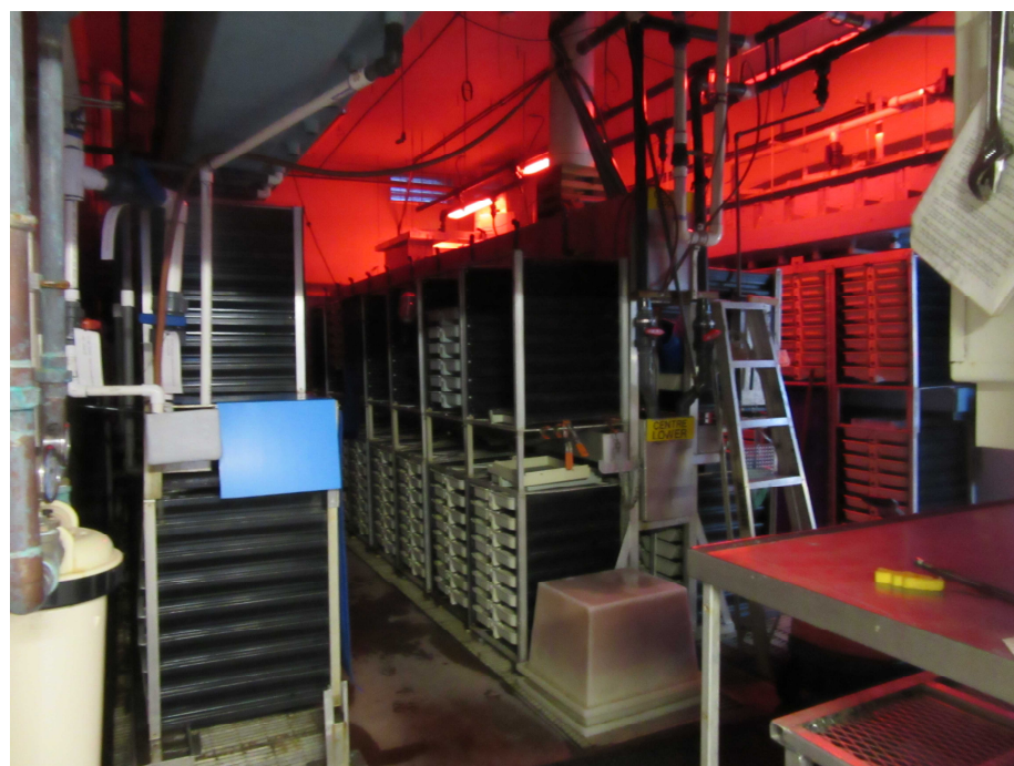
写真13 立体式孵化装置
